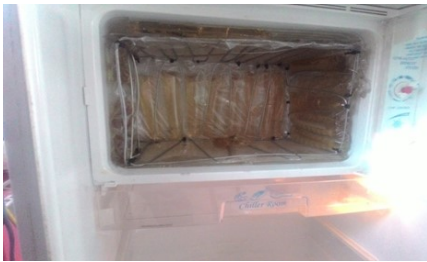
Gambar 1. Susunan PCM pada dinding evaporator
