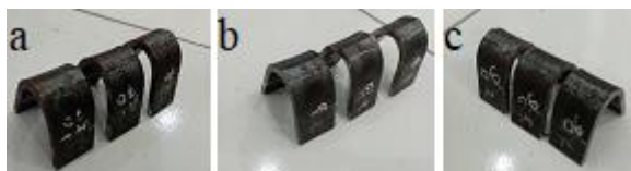
Gambar 12. Hasil uji bending arus las a. 70A, b. 80A, c. 90A
