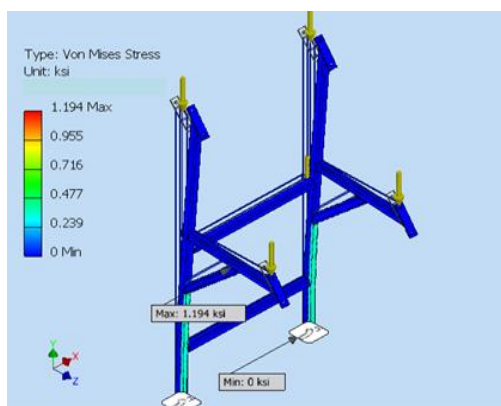
Gambar 14 Von Mises Stress pada rangka konveyor
