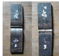
Gambar 4.1 pengujian bending tidak maksimal.
