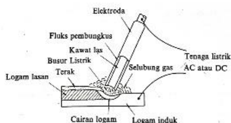
Gambar 2.1 Las Elektroda Terbungkus (Wirjosumarto and Okumura, 2008)
