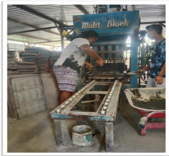
Gambar 1. Proses pembuatan menggunakan mesin Multi Block dengan seri SB-306
